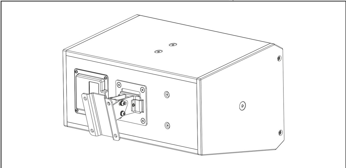
3. Successivamente, posizionare il diffusore sulla staffa di supporto installata a parete e serrare le due viti di sicurezza laterali.
